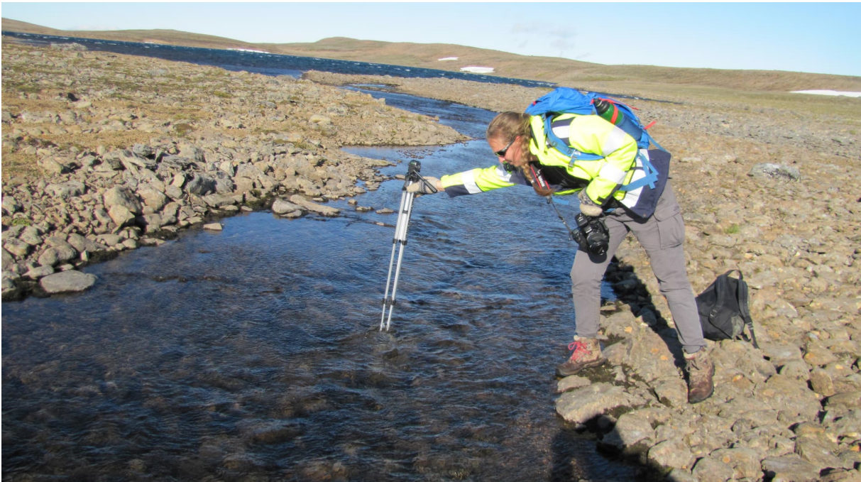
Mynd 4-5 Afrennsli Svartagilsvatns. Til bráðabirgða er reiknað með að grafa 2 m djúpan skurð á þessum stað til að lækka náttúrulegt vatnsborðið vatnsins.
